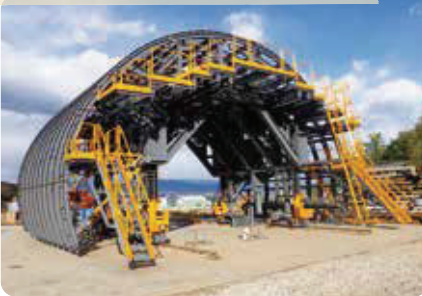
トンネル用移動式型枠(スライドセントル)
